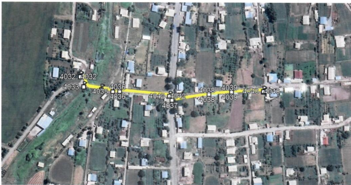
Рисунок 1 – Ситуационный план-схема подземного газопровода низкого давления села Ором - Участок №1 Ветвь №1
